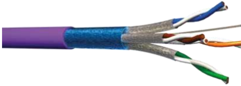
Rys. Przykładowy kabel F/FTP kat. 6A w powłoce LSZH, klasa CPR B2ca
